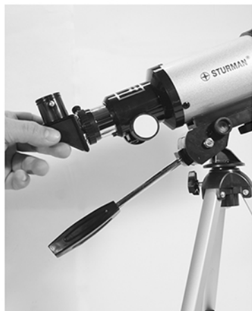
5. Установите диагональное зеркало в фокусер и зафиксируйте положение с помощью винта
