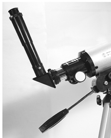
7. Для получения прямого изображения установите оборачивающую линзу или для увеличения кратности телескопа линзу Барлоу. Все зафиксируйте винтами
