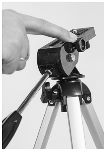
3. Убедитесь что стопорный винт не мешает установке телескопа
