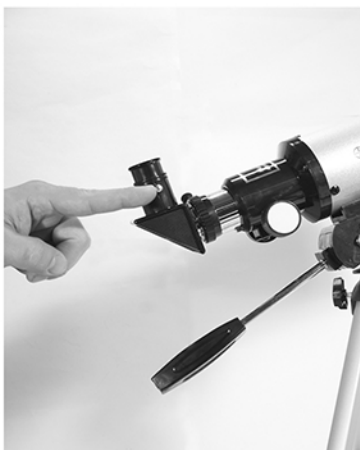
6. Установите окуляр в диагональное зеркало и зафиксируйте положение с помощью винта. Обратите внимание, что изображение в телескопе будет прямое зеркальное.
