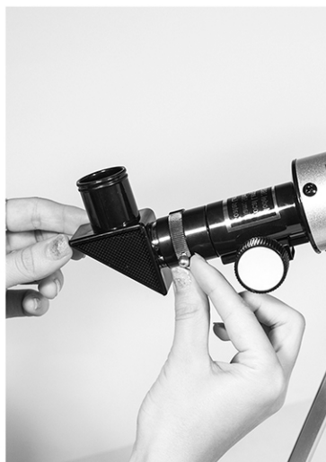
3. Установите диагональное зеркало в фокусер и зафиксируйте положение с помощью винта
