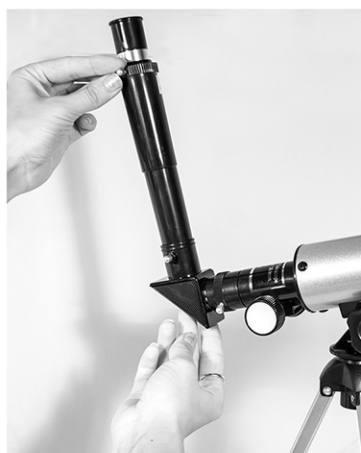
5. Для получения прямого изображения установите оборачивающую линзу или для увеличения кратности телескопа линзу Барлоу. Все зафиксируйте винтами
