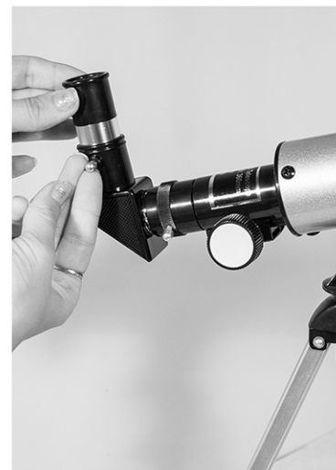
4. Установите окуляр в диагональное зеркало и зафиксируйте положение с помощью винта. Обратите внимание, что изображение в телескопе будет прямым зеркальным.
