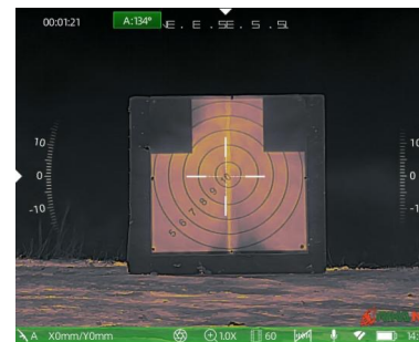
СТРОКА СОСТОЯНИЯ НАХОДИТСЯ В НИЖНЕЙ ЧАСТИ ДИСПЛЕЯ ПРИЦЕЛА
