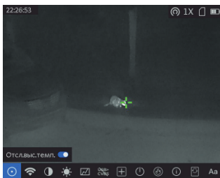
Рис. 4-1. Эффект отслеживания максимальной температуры
